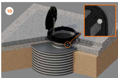
10 Σταθεροποιείτε το χυτοσιδηρό καπάκι στις γωνίες με βίδες αγκύρωσης.
